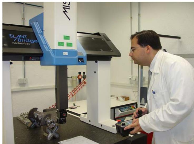
INGENIERÍA INVERSA Y MEDIDA MEDIANTE MÁQUINA 3D DE PRODUCTOS
