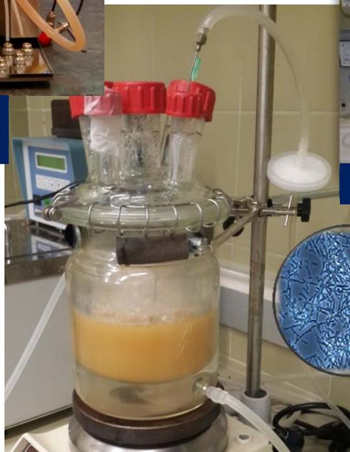
Biorreactores tanque agitado
