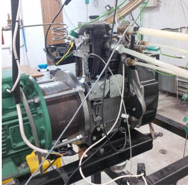
Instalación de ensayos para la investigación sobre el proceso de combustión en Motores Térmicos. Permite la medida de la presión en la cámara de combustión para el posterior análisis y cálculo de la velocidad de combustión.
