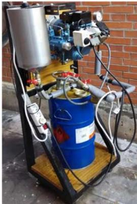
Quemador de pulverización mecánica por fluido
