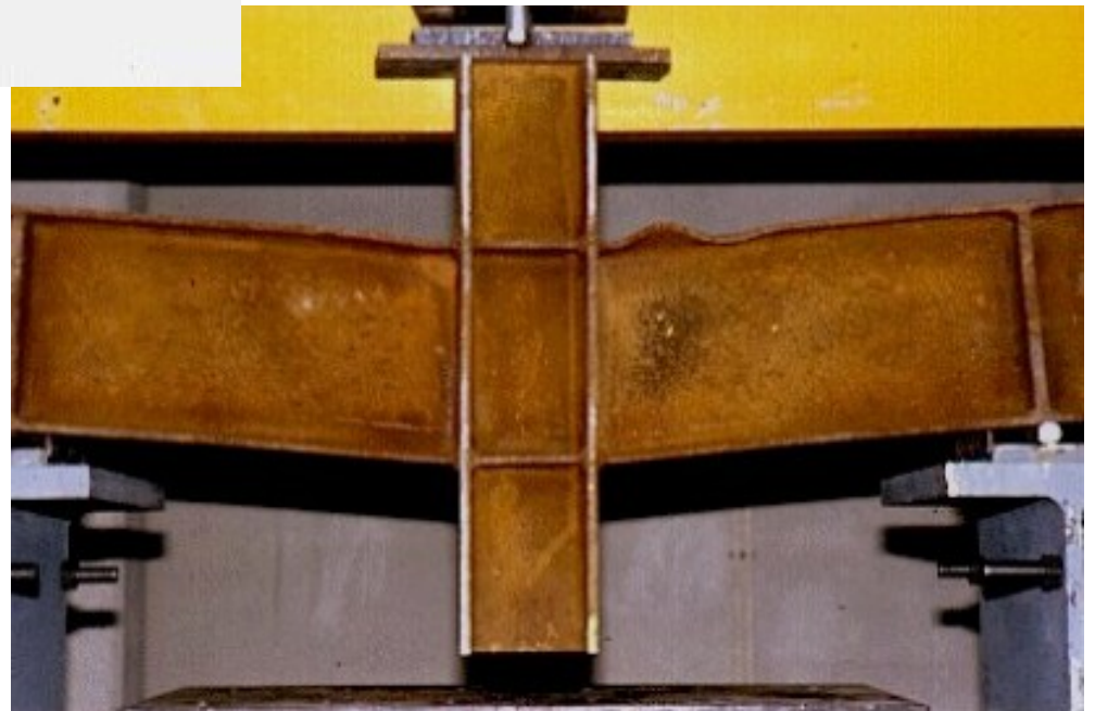
Alma de la columna reforzada. Fallo del ala de la viga.
