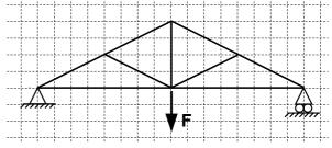
el nudo superior tiene impedido el movimiento fuera del plano del dibujo. La geometría es tal que los cuadrados de referencia tienen 0.7m de lado. (16ptos)
