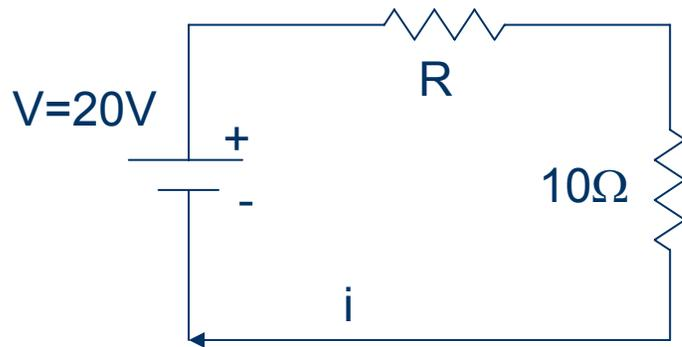
Encontrar el valor de R de modo que se maximice la potencia absorbida en dicha resistencia
