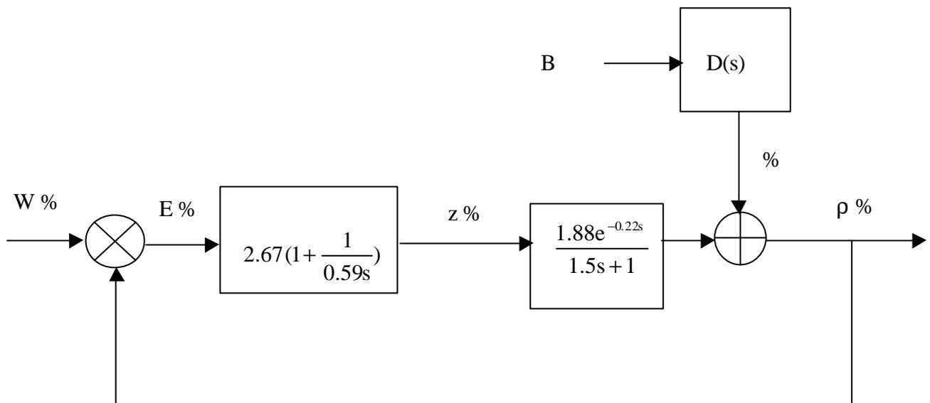
La salida del bloque D, desconocido, debe estar en %, mientras que la entrada puede figurar en l/min puesto que no sabemos nada del transmisor respectivo. Del diagrama se deduce la expresión de las funciones de transferencia que relacionan la densidad con la referencia y el caudal B:
