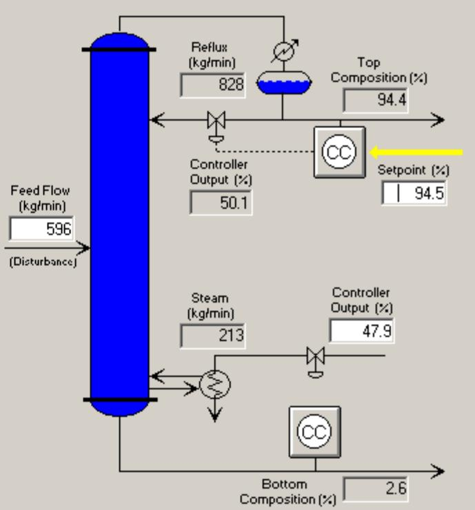
IMC tuning  $\lambda=50$  min.  $K_p = 2.19$ ,  $T_i = 70.85$  min.
