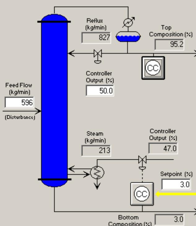
IMC tuning  $\lambda=35$  min.  $K_p = -5.47$ ,  $T_i = 45.2$  min.
