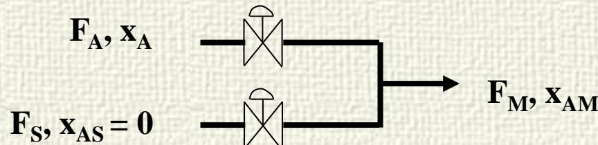
$$\begin{bmatrix} \Delta F_M \\ \Delta x_{AM} \end{bmatrix} = \begin{bmatrix} 1 \\ \frac{(1-x_A)F_A}{(F_s+F_A)^2} \end{bmatrix}_{ss} \begin{bmatrix} 1 \\ \frac{-F_A x_A}{(F_s+F_A)^2} \end{bmatrix}_{ss} \begin{bmatrix} \Delta F_A \\ \Delta F_S \end{bmatrix}$$
