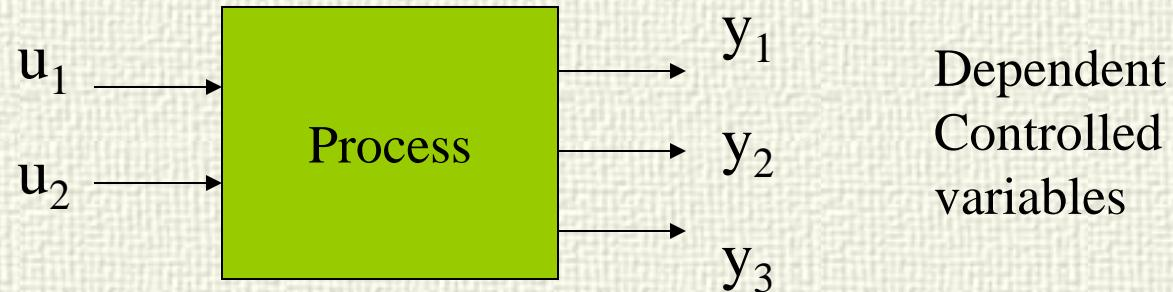
$$\begin{bmatrix} Y_1(s) \\ Y_2(s) \\ Y_3(s) \end{bmatrix} = \begin{bmatrix} G_{11}(s) & G_{12}(s) \\ G_{21}(s) & G_{22}(s) \\ G_{31}(s) & G_{32}(s) \end{bmatrix} \begin{bmatrix} U_1(s) \\ U_2(s) \end{bmatrix}$$
